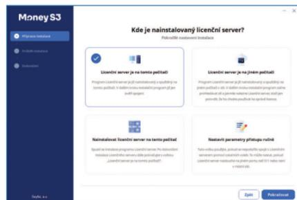
**Nastavit parametry přístupu ručně** – tuto volbu použijte, pokud se nepodařilo spojit s *Licenčním serverem* pomocí ostatních voleb. To může nastat, pokud *Licenční server* naslouchá na jiném portu než 511 nebo není v místní síti.
